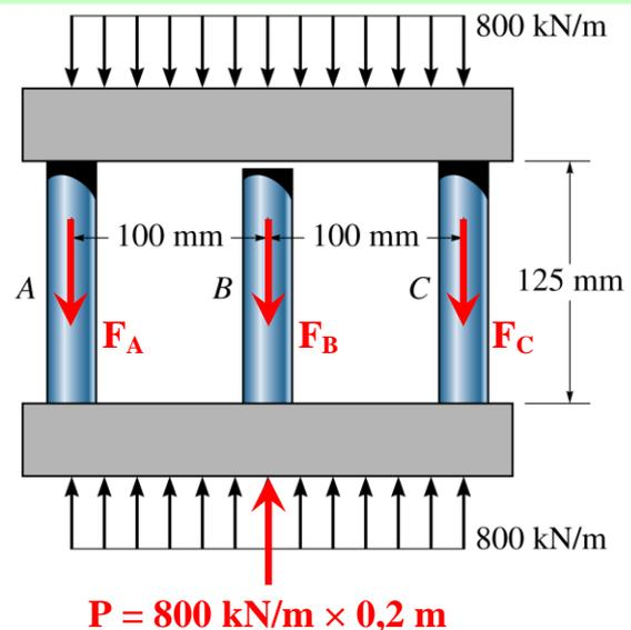
**Resposta:** As tensões normais médias atuantes nas colunas A, B e C são **189 MPa, 21,4 MPa e 189 MPa**, respectivamente.
