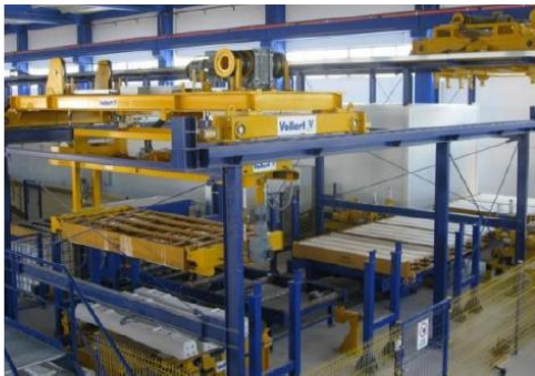
c) desmoldagem das peças por meio do giro das fôrmas;
