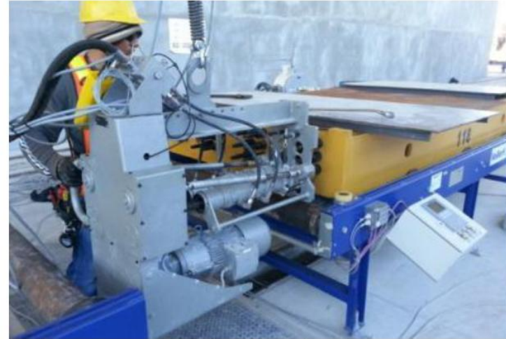
b) estiramento dos fios de protensão com equipamento projetado especificamente para o dormente fabricado;
