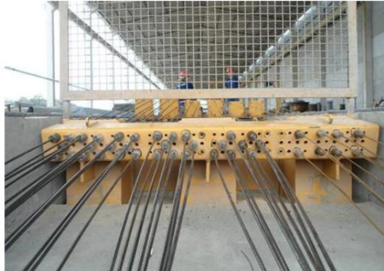
Figura 1.33 – Operação de estiramento de cordoalhas e fios na ancoragem ativa da pista de protensão. (Fonte: Weiler-C.Holzberger Ind. Ltda, http://wch.com.br )
